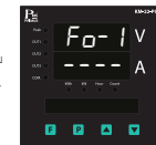
แสดงค่า Previous Fault Output 1
