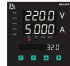
แสดงค่า Volt, Current, kWh
