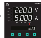
แสดงค่า Volt, Current, Digital Counter
