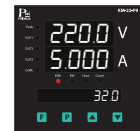
แสดงค่า Volt, Current, kWh
