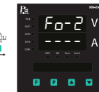
แสดงค่า Previous Fault Output 2
